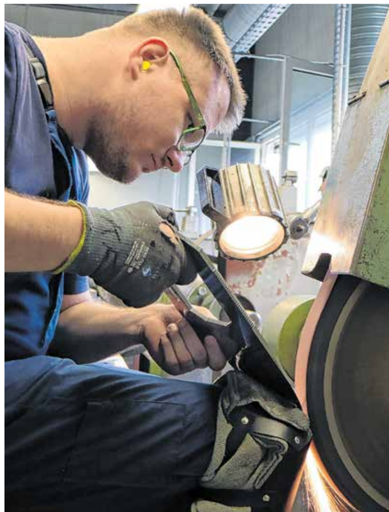
Geschick gefragt: Felix König (oben links) schleift ein Kuttermesser. Der Winkel für die Schneide hat einen vorgegebenen Wert und die Kunst ist, den genau zu treffen. Spiegelblank poliert – so sieht ein Messer am Ende aus. Maik Paflack (oben rechts) arbeitet seit zwölf Jahren im Betrieb. Der US-Amerikaner Ivo Cozzini (r.) hat die Firma gekauft. Sohn Alexander leitet das deutsche Unternehmen. Fotos: Ina Matthes
